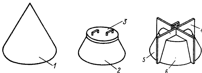
Рис. 13-9. Сокращение пробы методом квартования
