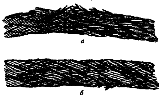
Рисунок 3. Обрывы проволок в зоне уравнительного блока:
